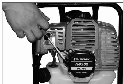
Рис. 7. Свободный ход шнура стартера
