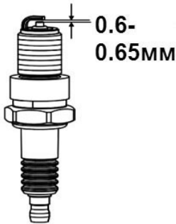
Рис.13. Свеча зажигания
