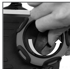
Рис.4 Снятие крышки шины
