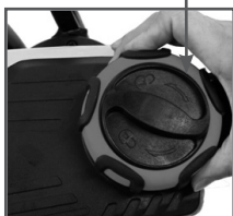
Рис.7 Регулировка натяжения цепи
