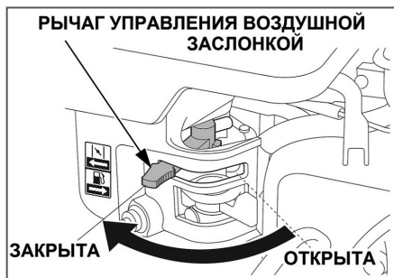
Рис. 9 Положения рычага управления воздушной заслонкой
