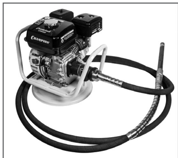
Рис. 6 Вибратор с установленным гибким валом с вибронаконечником
